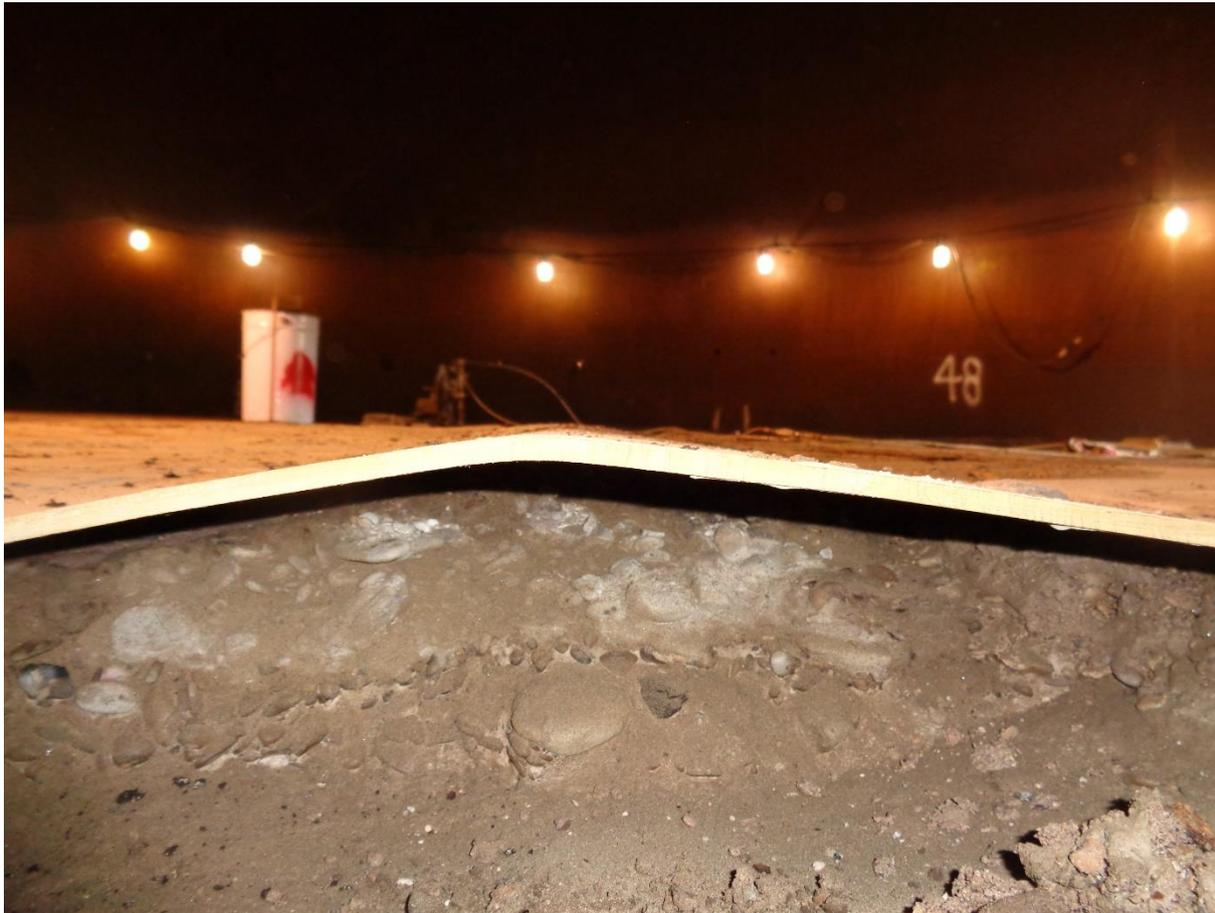
Il fondo del serbatoio è ispezionato su tutta la sua superficie mediante l'applicazione di un campo magnetico disperso; l'attrezzatura può anche essere interfacciata ad un sistema informatico in grado di fornire una rappresentazione della severità e della posizione dei singoli difetti su ogni lamiera.
